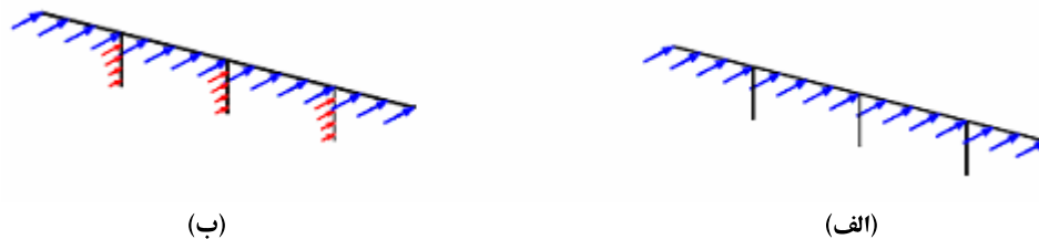
شکل ۲. گزینه های اعمال بارگذاری جانبی در راستای عرضی (الف) اعمال بار در عرشه (ب) اعمال بار در عرشه و پایه ها [۱]
