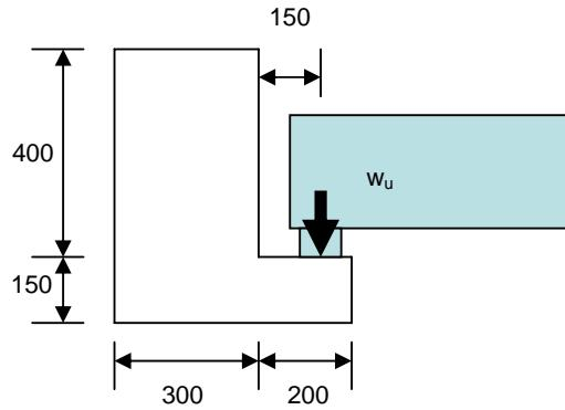
1- شکل مقابل مقطع یک تیر دو سر گیردار به طول 5 متر را نشان می دهد.
